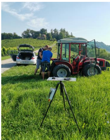
Slika 1c: Namestitev DGPS merilnega sistema v bližino lokacije vinograda.
