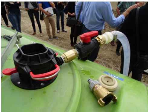
Slika 3: En del EasyFlow je zmontiran na škropilnico ali pršilnik. Na tem adapterju je cevni nastavek za povezavo z vodovodno cevjo. Z vodo se opere ali samo adapter, ki se nahaja na kanistru (ob delno izpraznjenem kanistru), ali pa se spere (očisti) celoten (prazen) kanister.
