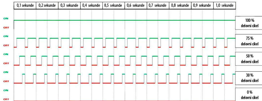
Slika 3: Shema delovanja PWM sistema, ki deluje pri 20 Hz. Vir slike: TeeJet
