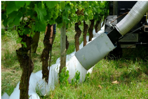
Slika 8: Tecnovict proizvaja napravo Schiumone – ekološko napravo za termično uničevanje plevelov z vročo peno.
