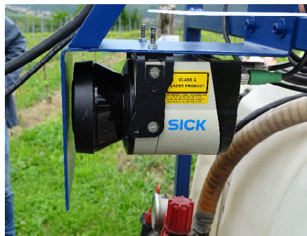
Slika 5: LIDAR oziroma laserski skener posname gostoto zelene stene z listno površino vinske trte in morebitne prostore brez listne površine.
