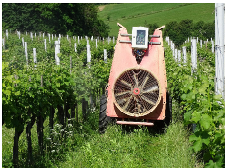
Slika 4: Pršilnik standardne izvedbe nadgrajen s slovenskim sistemom za ciljno nanašanje škropiva s PWM sistemom na osnovi LIDAR kamere.
