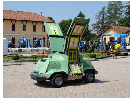
Slika 7: Avtonomni robot Free Green Nature S.R.L Icaro X4 z ultravijoličnim sistemom za preventivno varstvo vinske trte pred peronosporo, oidijem in botritisom.
