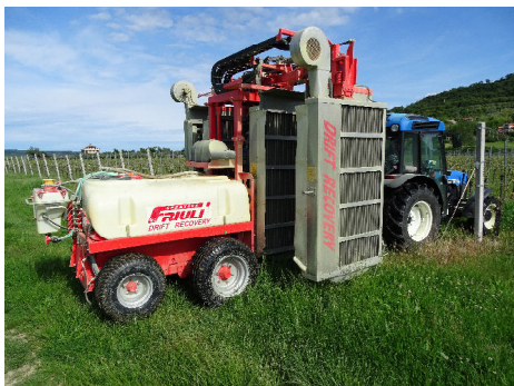
Slika 1: Agricolmeccanica Friuli Sprayers Drift Recovery 1000 je reciklažni tunelski tip pršilnika.
