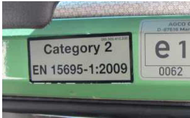
Slika 1: Nalepka (tablica) v kabini traktorja označuje vrsto kabine glede na stopnjo zaščite v skladu s zahtevami SIST EN 15696.
