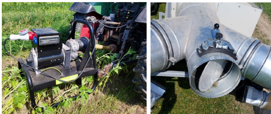
Slika 2: Agregat moči 21 kW (levo) in položaj lopute in položaj lopute "zaprt" (desno).
