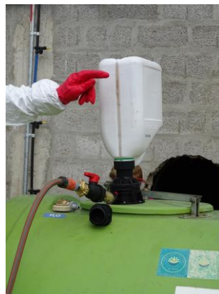
Slika 2: EasyFlow sistem v delovanju, ko sta oba adapterja združena. To predstavlja CTS sistem – zaprt sistem odvzema tekočega koncentriranega FFS iz kanistra. Na kanistru je merilna skala, ki omogoča določitev potrebne količine FFS.
