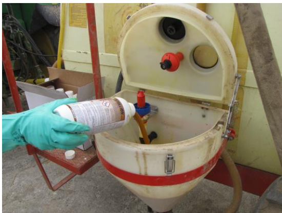
Slika 1: Polnilne posode pripomorejo k boljši varnosti uporabnika FFS, z njimi lahko tudi spiramo prazno embalažo FFS. Ni pa to zaprt sistem odvzema koncentriranega škropiva.
