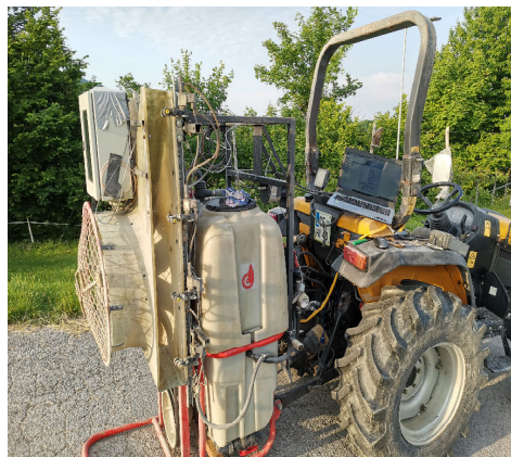
Slika 1b: Avtomatiziran prototip pršilnika za kontrolirano nanašanje škropilne brozge v ekološkem vinogradu.
