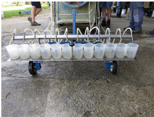
Slika 2: Enakomeren volumski pretok po merilnih valjih pri uporabi novih šob ATR sive barve.
