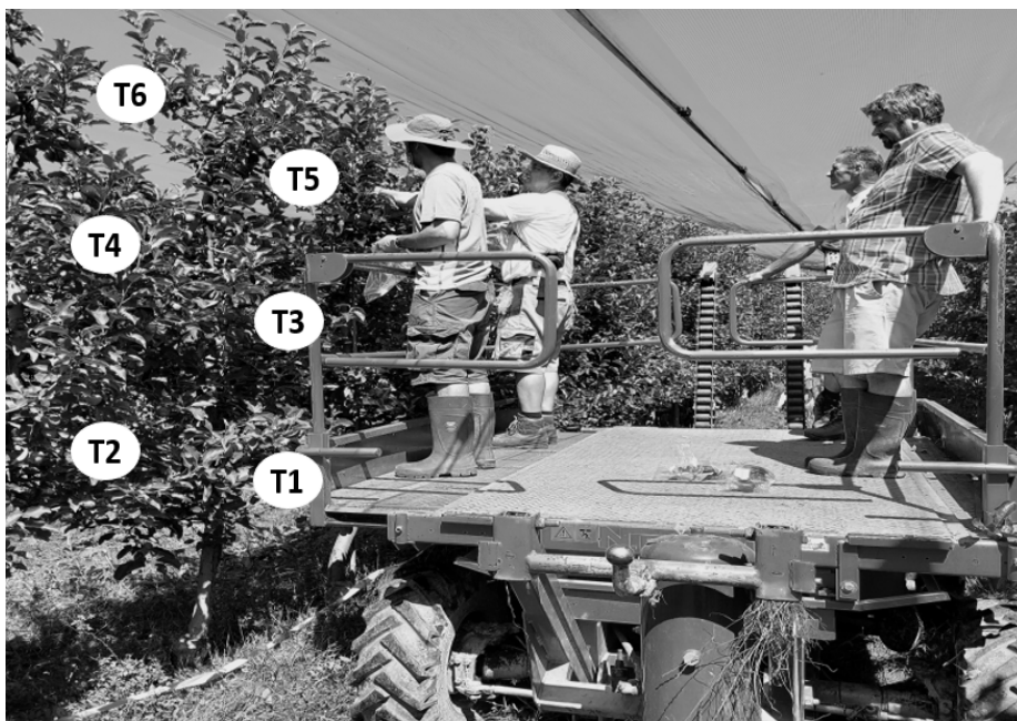
Slika 1: Položaj na vodo občutljivih lističev (WSP) v krošnji dreves za ocenjevanje porazdelitve škropilne brozge.
